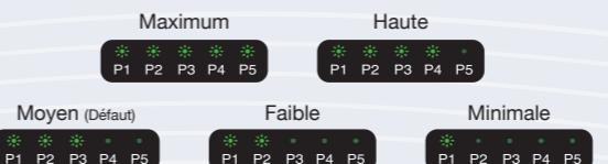
L'intensité s'applique donc à tous les programmes sélectionnés jusqu'à ce qu'elle soit à nouveau modifiée (reste en vigueur même après la mise hors tension de l'appareil).
