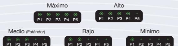
Así, la intensidad se aplica a todos los programas seleccionados hasta que se cambie nuevo (se mantiene incluso después de apagar el aparato).
