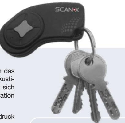
Mit dem Modul SCAN-X kann man das elektromagnetische Feld mittels akustischem Signal anzeigen und eignet sich daher auch als wirksame Demonstration für Interessierte.
